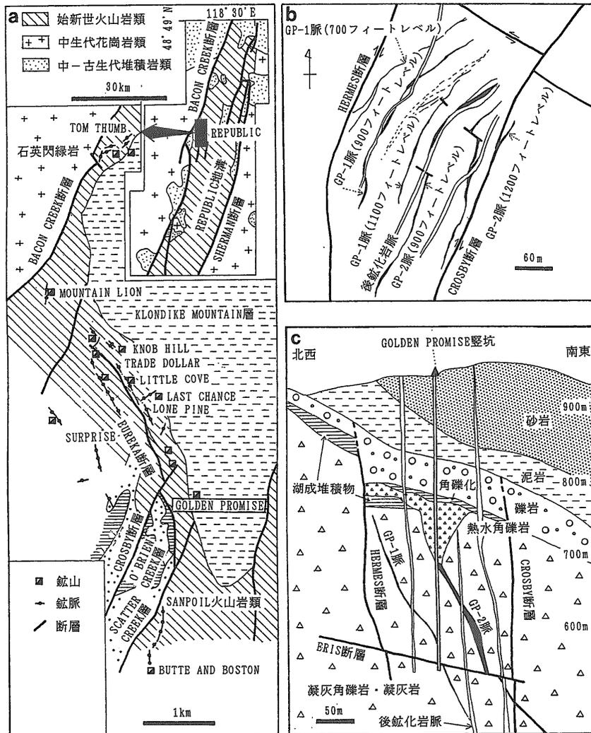
第3図 Golden Promise 鉱床。a: 地質図 (Staatz and Pearson, 1990; Devlin, 1993を修正), b: 鉱脈図, c: 鉱床断面図 (b, cは Devlin, 1993を簡略化)。
