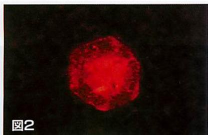
図2 水晶(荒川鉱山産;c軸に垂直な断面)のTLCI, 断面径:0.8cm.
