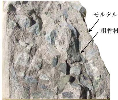
図7 コンクリート試験片の破壊面 (骨料A)
