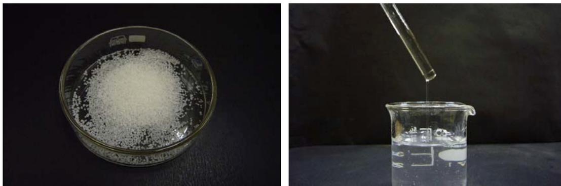
図4 掘削泥水用に市販されている PHPA ポリマー
