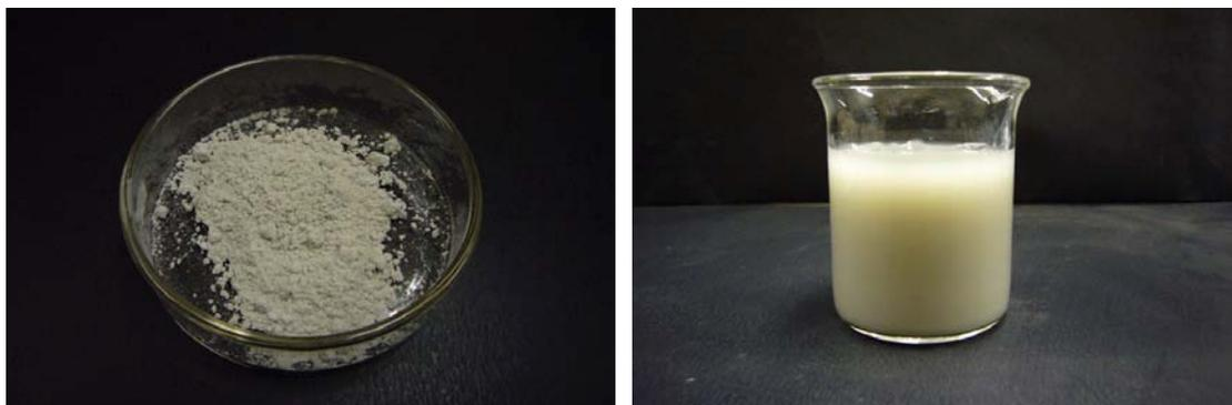
図1 掘削泥水用に市販されているベントナイト (左: 粉末の状態, 右: 約6%濃度の懸濁液)
