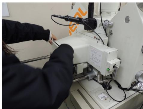
3. 緑色ランプの点灯(試料交換室が大気圧状態)を確認し, 緑色点灯ボタンを押す(真空引き開始).
