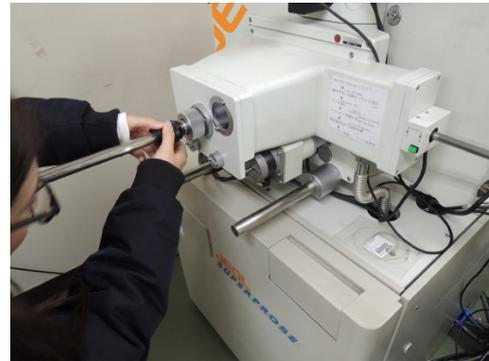
6. サンプル挿入棒をゆっくりと最後まで引っ張る。このとき、のぞき窓からのぞきながら、試料ホルダーが装置内に設置されていることを確認する。
