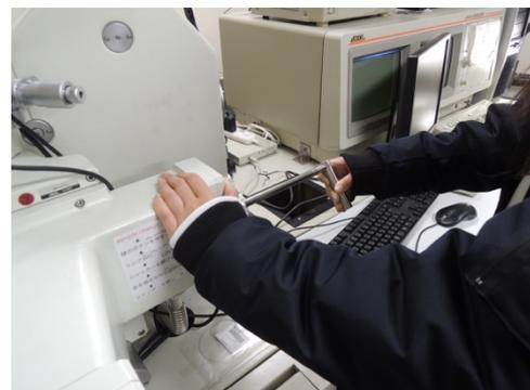
5. 試料交換棒をゆっくり挿入する。最後まで押し込んだら時計回りに回す。
