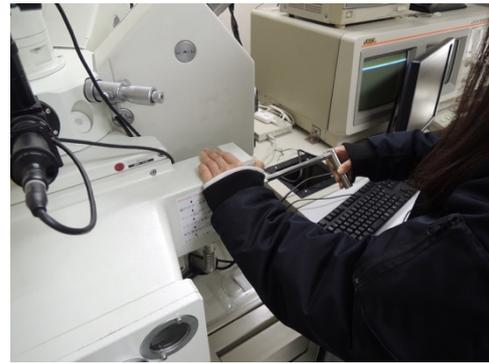
5. のぞき窓からホルダーが移動する様子を確認しながら、サンプルホルダーをゆっくり挿入する。最後まで押し込んだら、反時計回りに回す。
