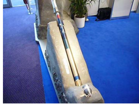
Tesco 社の BHA 回収方式のケーシング掘削用編成
