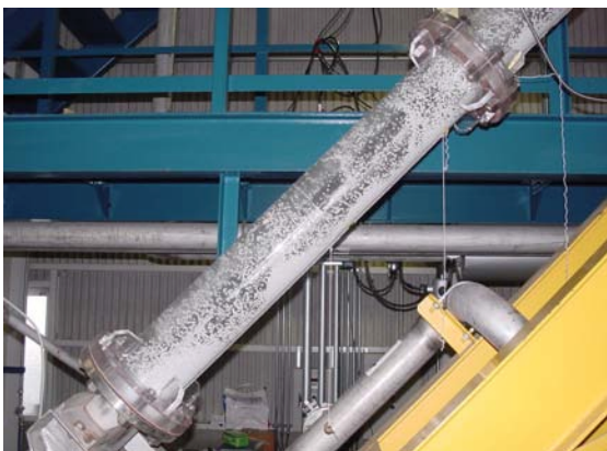
図10 傾斜坑井のカッティングス運搬挙動
