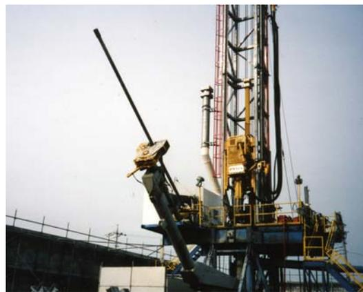
図 11 セミオートマチック小型電気リグ 610-E (左：掘削リグ全景，右：パイプラックからやぐら下へドリルパイプを移動しているところ)
