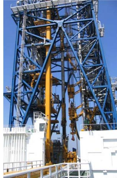
図 10 地球深部探査船「ちきゅう」(左：掘削船全景，右：パイプハンドリングシステムを備えたやぐら下の様子)
