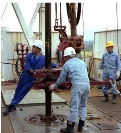
図8 トンクを使ったツールジョイントのねじの締め戻し作業
