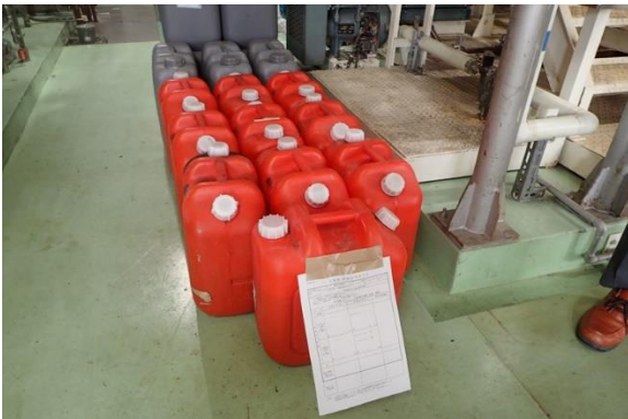
(悪い例) 一部の容器にしか貼っていない
