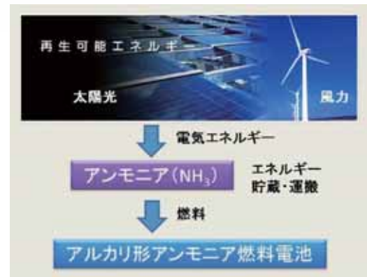
図1 エルギー貯蔵体としてのアンモニアとアルカリ形アンモニア燃料電池
