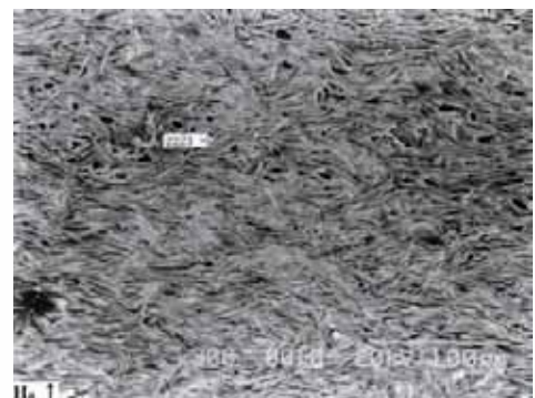
図 3 温度勾配と強磁場を同時に付加して焼結試料の SEM 写真
