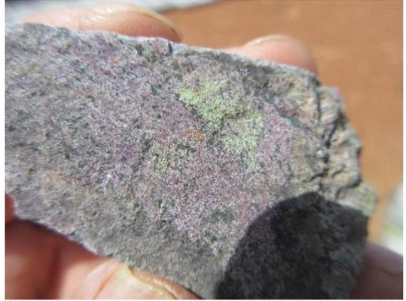
ザンビアの堆積岩胚胎銅鉱床で行われた試錐コア(左図)。コア中に見出されたコバルト含有鉱物(ピンク色の部分)(右図)。
