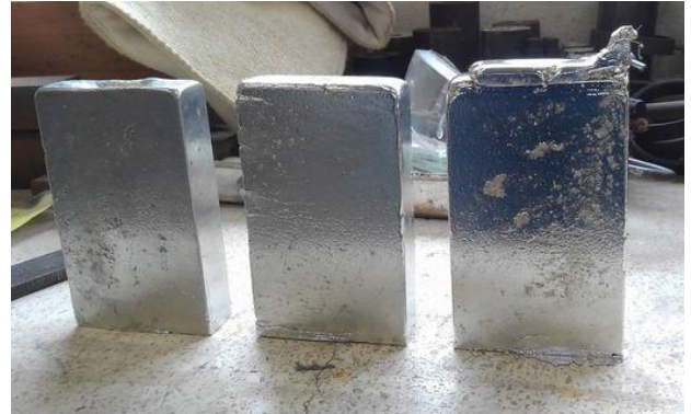
図1 鋳型から取り外した SAC はんだ
