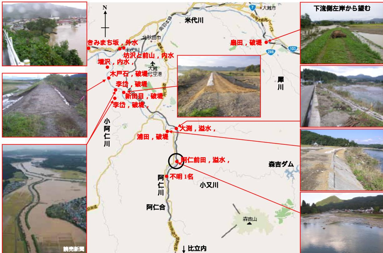
図-1 米代川流域の主な被災地と被災分類（破堤，溢水，外水，内水）(Google マップに加筆)
