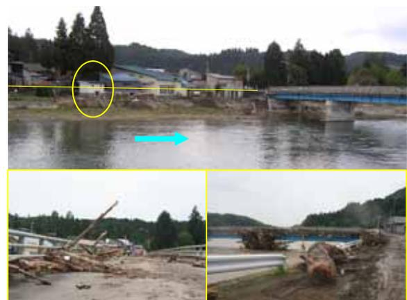
写真-3 左岸の上流(上段)から下流の八幡橋(下段)にかけての浸水位線(写真中の実線)
