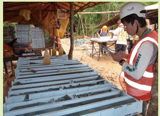
フィリピンの鉱床探査地域における試錐コアの観察
