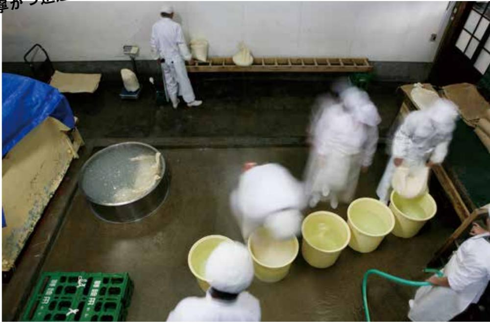
精米した米は割れやすいので、手作業で慎重に洗米を行う。浸漬は米の品種やその日の気候、湿度などの条件を見て、水温や時間を変えて行われる。氷水に浸けるのも、温度調整のためだ。
