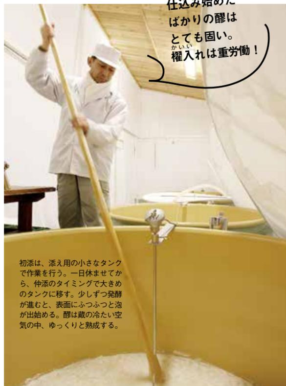
初添は、添え用の小さなタンクで作業を行う。一日休ませてから、仲添のタイミングで大きめのタンクに移す。少しずつ発酵が進むと、表面にふつふつと泡が出始める。醪は蔵の冷たい空気の中、ゆっくりと熟成する。
